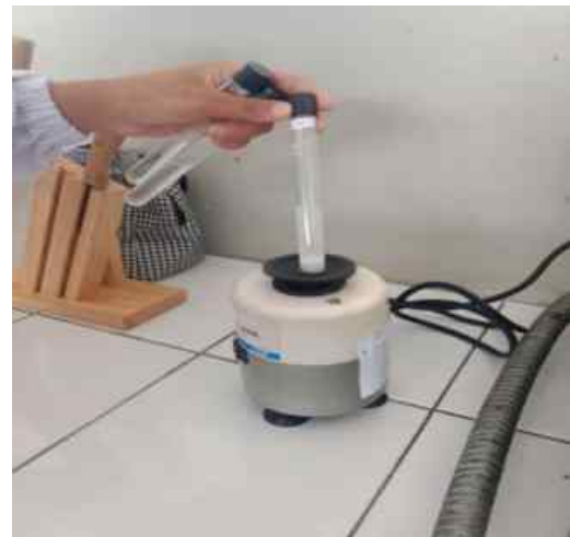
Membuat larutan homogen antara sampel dan cairan aquades dengan menggunakan alat vortex mixer
